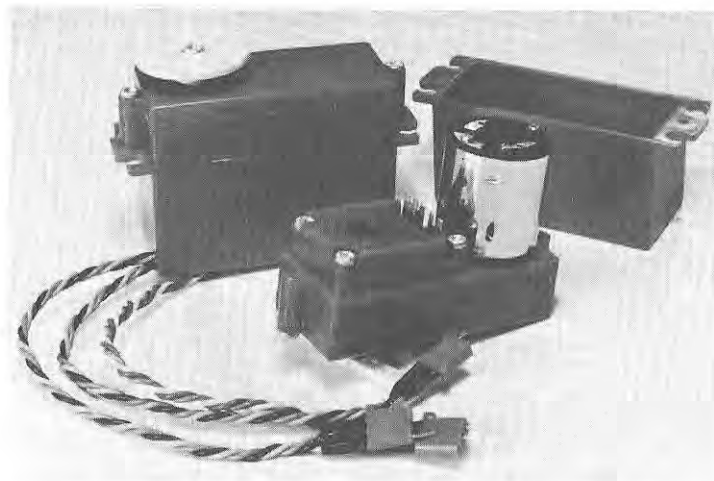
Photo V.-B. — Les mécaniques LX76 modifiées. Remarquer la sortie des lames permettant la soudure des liaisons, à l'intérieur du servo-mécanisme.
