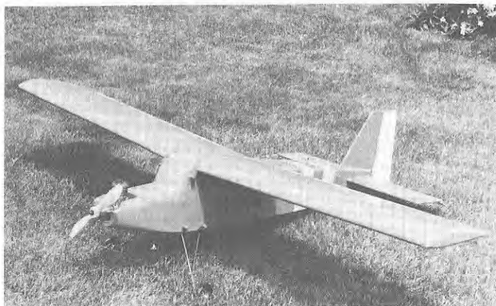
Photo VI.-C. — L'avion de début doit être à ailes hautes, fuselage bien dimensionné pour une installation facile. Le moteur sera de 2,5 \text{ cm}^3 et l'envergure voisine de 1,25 m.
